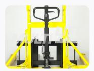
La función de elevación puede ser operada con la palanca de levante o por medio de un pedal.
